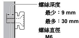
用作將電視機安裝在壁掛式支架上的螺絲(沒有隨電視機提供)
