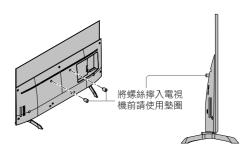
• 壁掛式支架的安裝插孔
